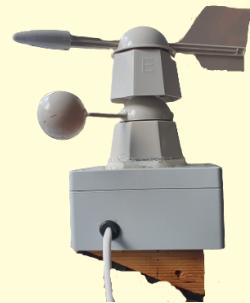
La girouette et l'anémomètre : Elle ne doit pas être à l'abri du vent et doit être placée au-dessus si cela est possible (sur le toit). Il faut impérativement qu'elle soit parallèle au sol et son orientation doit bien correspondre à celle du Nord en fonction de la localisation.
