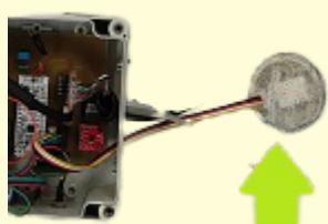
Le DHT22 : Il doit être placé en dessous de la ruche mais en dehors du boîtier.
